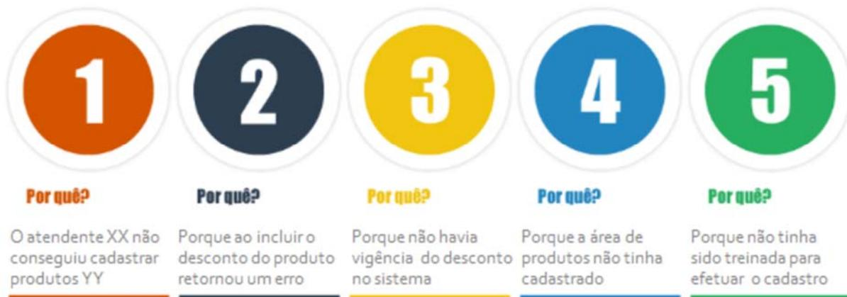
Figura 2.4 – Identificação da causa raiz através da análise de 5 Porquês
