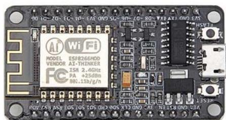
Figura 3.4 NodeMCU modelo ESP8266
