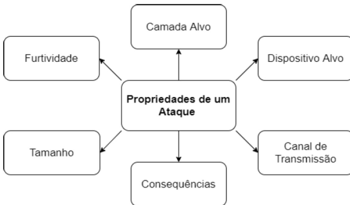
Figura 2.7: Diagrama das Características de ataque a uma rede IoT
